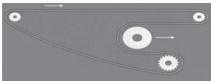
Ausführung 2: Zweimal Eingriffsrollen, ein negative Knickung, eine Antriebswelle.
