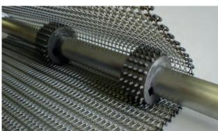
**BS-KK** 5,08 - 6,35 / 0,9 - 1,2 : Adjusting the sprockets to the belt
